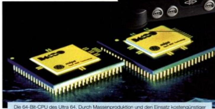
Die 64-Bit-CPU des Ultra 64. Durch Massenproduktion und den Einsatz kostengünstiger Technologie soll SGIs R4300i-Chip weniger als 30 US-Dollar (etwa 45 Mark) kosten.
