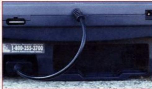
Die Anschlüsse des Tristar64: Links stöpselt Ihr das AV-Kabel ein, rechts das Netzteil.
