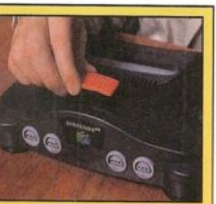
Le Memory Extension Pack ne peut être installé qu'en relation avec le 64DD. Il double la capacité mémoire, et donc de traitement de l'information, de la N64.
