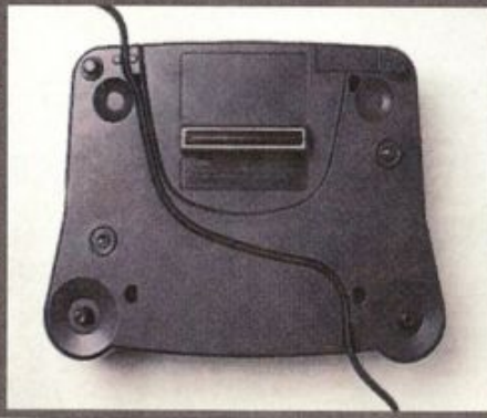
Une étrange rainure court tout le long de la surface inférieure du 64 DD. Elle sert à faire passer un câble qui se branche sur le port manette n°4.
