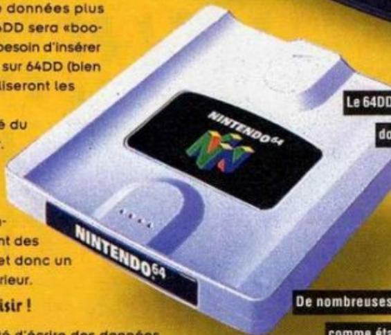
Le 64DD se glissera sous la console Nintendo 64. Ce nouveau support se connecte par le biais du connecteur «extension» situé sous la machine.
